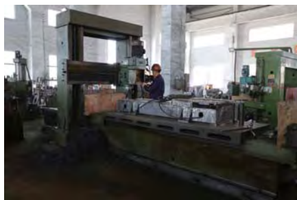
脱硫泵底板加工
