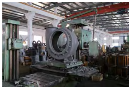
脱硫泵泵壳加工
