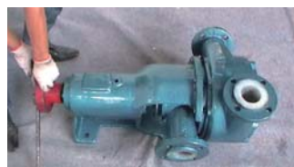
36. 固定联轴器, 防止主轴转动
