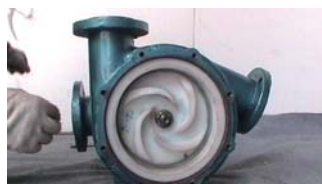
35. 逆时针方向旋上防转螺母
