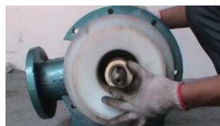
20. 套入前轴套（台阶深的一端朝外）
