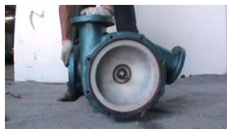
29. 将吸入口三通接管调节至水平位置
