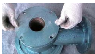
12. 安装密封盒压盖（内侧有台阶端朝下）
