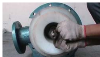
19. 在主轴前端套入前轴套垫
