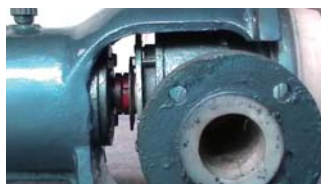
18. 装上装配好的吸入口三通接管组件
