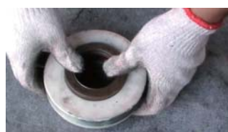
8. 装入第三只K形密封圈（唇口向下）
