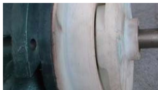
25. 检查一级叶轮与后泵盖之间的间隙 ※注②
