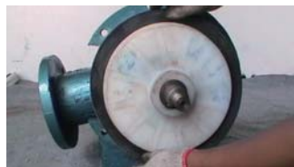
26. 在后泵盖上套入后泵盖垫
