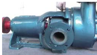
28. 用螺栓连接, 注意: 此时无需将螺栓拧紧
