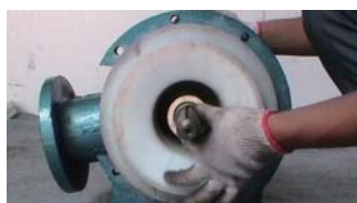
21. 套入叶轮顶圈
